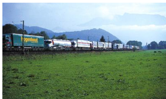
Slika 7. „Rolling road“ sistem transporta
